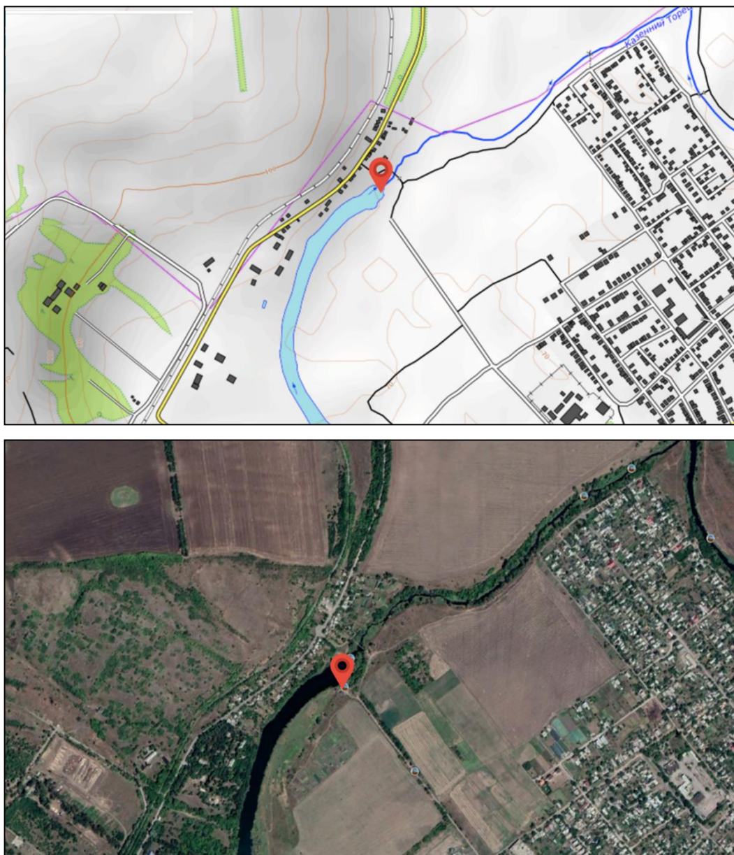
Рис. 1. Гребля на р.Казенний Торець: а) топографічна карта; б) космічні знімки програми Google Earth Гребля побудована у 1937 році, довжина по гребню 15 м, ширина – 8 м, створює підпір (рис.2).
